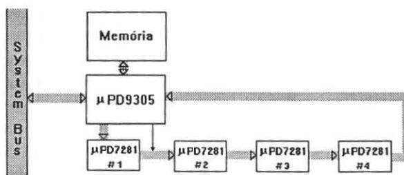
O  $\mu$ PD9305 é responsável pelo carregamento na memória, de um arquivo com um programa gerado em um computador PC. Em seguida este programa é transformado em uma sucessão de *fichas* pelo  $\mu$ PD9305 que as encaminha para execução no interior dos diversos processadores  $\mu$ PD7281 interligados em cascata.
