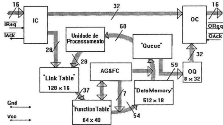
Fichas de 32 bits chegam em um  $\mu\text{PD7281}$ , através do barramento de entrada de 16 bits, são convertidas pelo controlador de entrada *IC* e, conforme seu destino seja o processador corrente ou um outro processador, encaminhadas para o "pipeline" interno ou para o controlador de saída *OC*.
