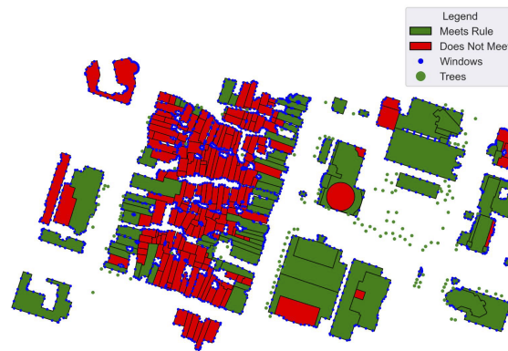
Figura 3. Resultado final mostrando edifícios que atendem (verde) ou não (vermelho) à regra 3 de visibilidade mínima às árvores.
