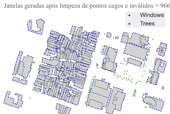
Figura 1. Janelas geradas em cada face das edificações depois da remoção de janelas cegas simuladas em paredes conjugadas, totalizando 966 válidas.
