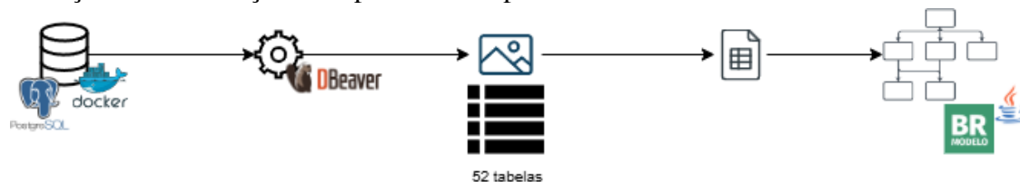
Figura 1: Esteira de execução do processo de engenharia reversa do banco de dados do Machine Teaching.
