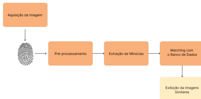
Figura 1. Visão macro de um pipeline de reconhecimento de impressões digitais.
