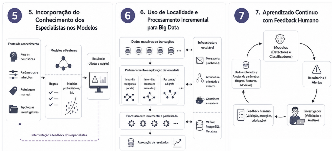
Figura 3. Diretrizes 5, 6 e 7 do projeto: incorporação do conhecimento dos especialistas nos modelos, uso de localidade e processamento incremental para Big Data , e aprendizado contínuo com feedback humano.
