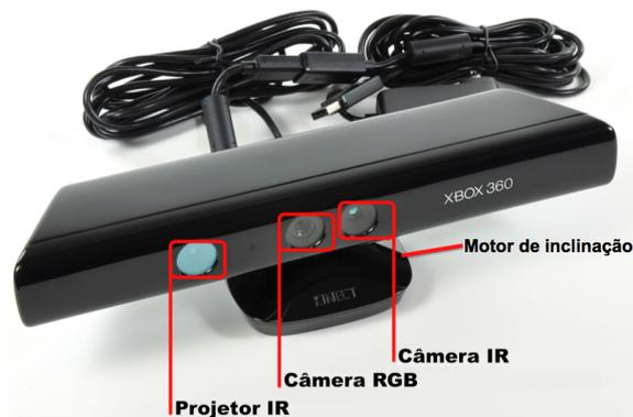
**Figura 1. Estrutura do Kinect**
