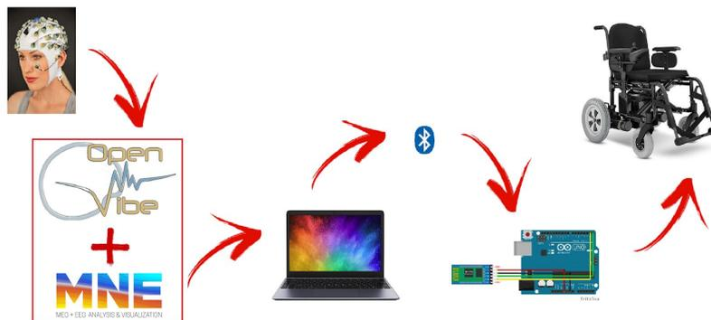
**Figura 3. Esquemático do hardware e software utilizados.**
