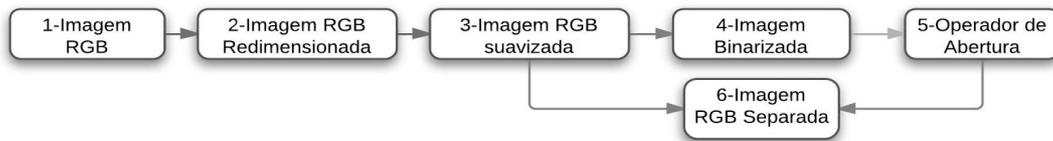
**Figura 2: Diagrama do funcionamento da etapa de Pré-Processamento.**
