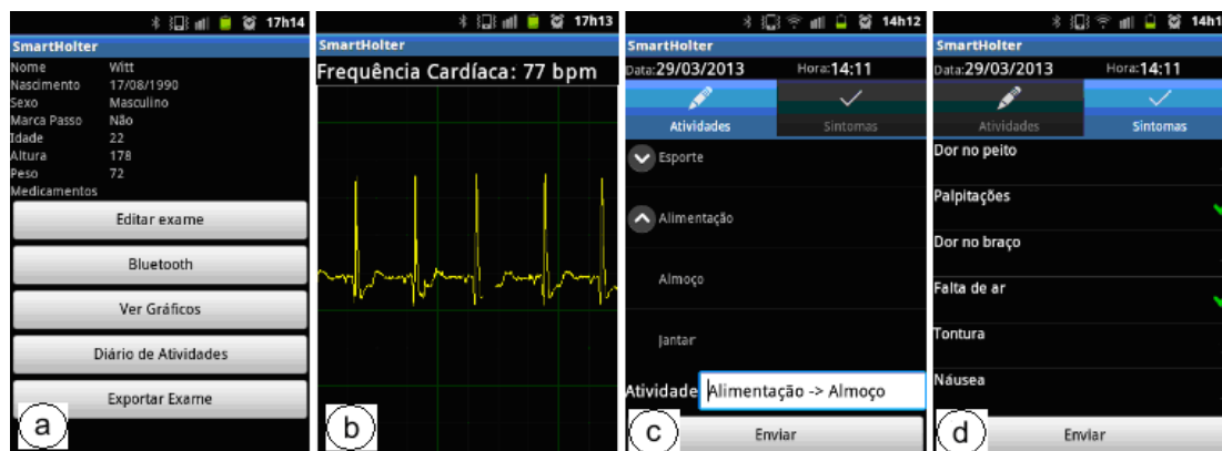
Figure 2. Telas da aplicação no SmartPhone: (a) Menu principal da aplicação, (b) visualização do sinal e frequência cardíaca, (c) tela de atividades realizadas e (d) tela de seleção e registro de sintomas.
