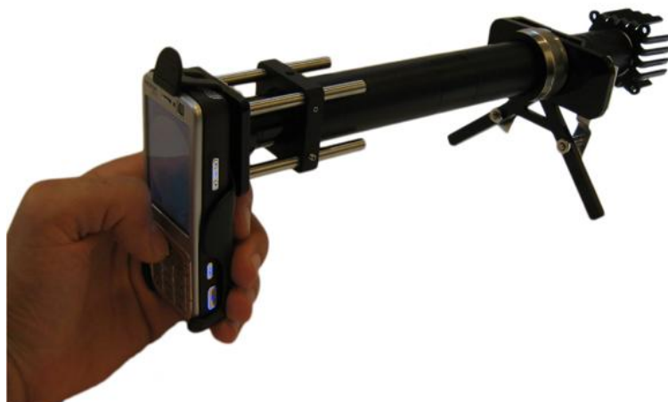
Figura 2. Foto do microscópio construído através de lentes de aumento acopladas à câmera de um aparelho celular [Breslauer et al. 2009].
