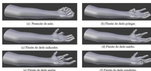
**Figura 3. Seis movimentos básico da prótese virtual.**
