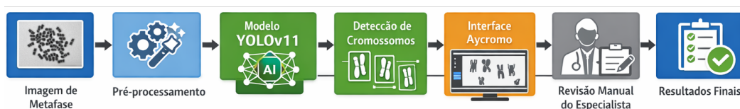
Figura 1. Pipeline do Aycromo. A imagem de metáfase é submetida ao modelo selecionado e as previsões são exibidas para revisão e correção manual pelo especialista.
