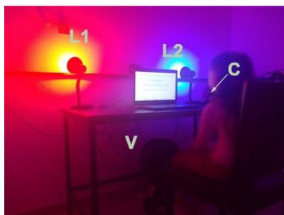
**Figura 2. Montagem dos estudos com a utilização de computador para ler o texto, lâmpadas RGB, ventilador e difusor de cheiro.**
