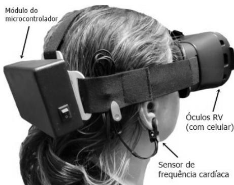
**Figura 2. Teste inicial do sistema em sua montagem final**
