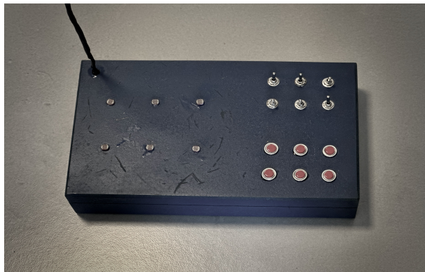
Figura 1: Interface com seis fotoresistores
