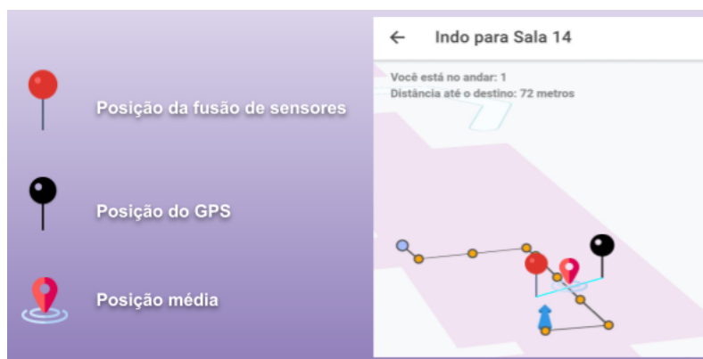
Figura 5. Ponto médio entre possíveis posições da fusão de sensores e GPS calculados.
