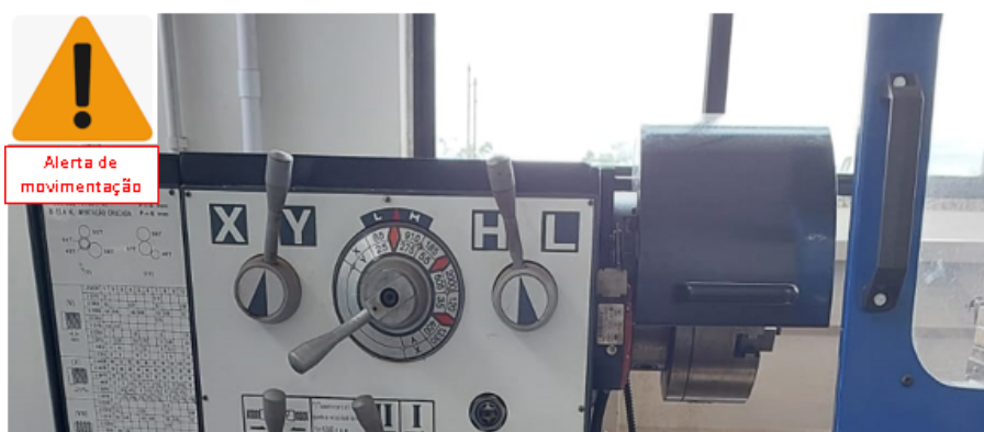
Figura 3. Alerta de movimento - visão do usuário com ativação do sensor de movimento do lado esquerdo.
