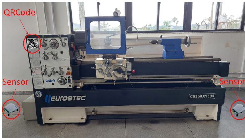
Figura 1. Exemplo de área de monitoramento (ponto de trabalho) - uma máquina a ser operada por um colaborador, o QRCode com a identificação da posição e dois sensores de presença (um de cada lado) para detectar perigos.
