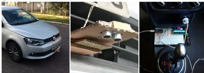
A Figura 4 mostra 3 fotos que exemplificam a instalação do sistema no veículo. A primeira mostrando a posição da instalação do sensor na parte frontal, a segunda mostrando o *case* criado e montado manualmente que envolve o sensor para apoiá-lo e protegê-lo, e a terceira a instalação da placa controladora no interior do veículo.
