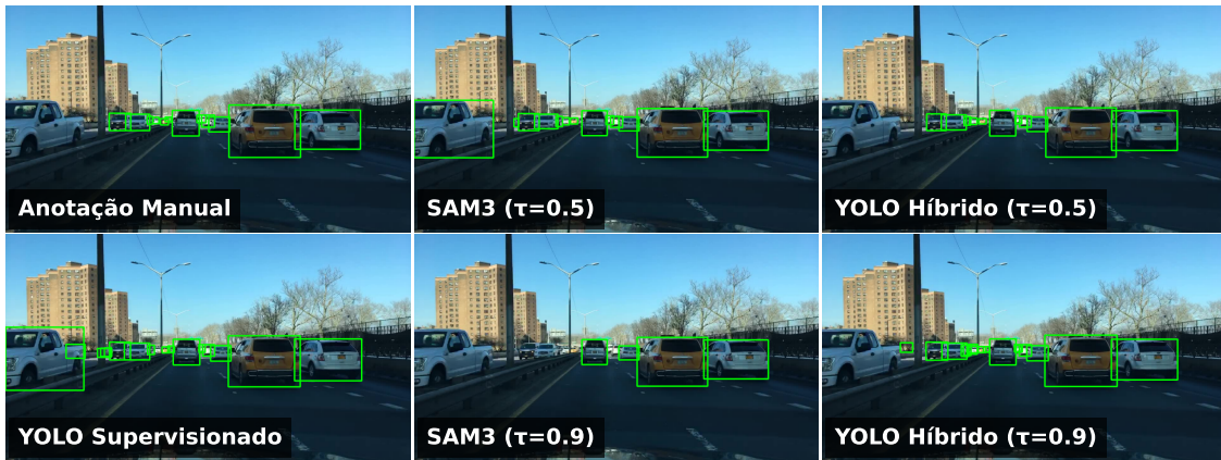
Figura 3. Comparação qualitativa entre anotações manuais referentes apenas à classe carro, produzidas pelo SAM3 e previsões do modelo YOLO treinado na configuração híbrida simétrica utilizando 5% de dados rotulados manualmente. Previsões consideram filtragem por confiança com limiar \tau = 0,5 e \tau = 0,9 .
