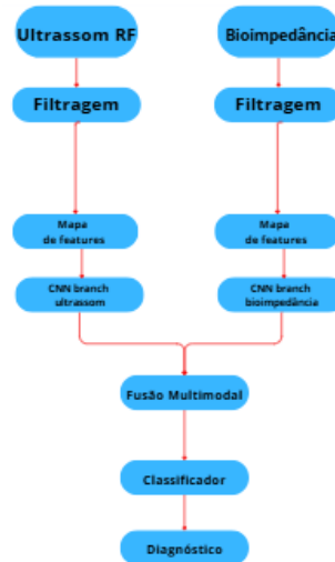
Figure 1. Arquitetura do sistema embarcado proposto, com módulos de ultrassom e bioimpedância integrados à plataforma Raspberry Pi e fluxo de dados até a saída probabilística da CNN multimodal.
