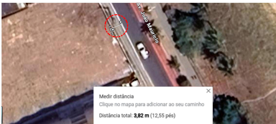
Figura 3 - Exemplo de medição manual da calçada.
