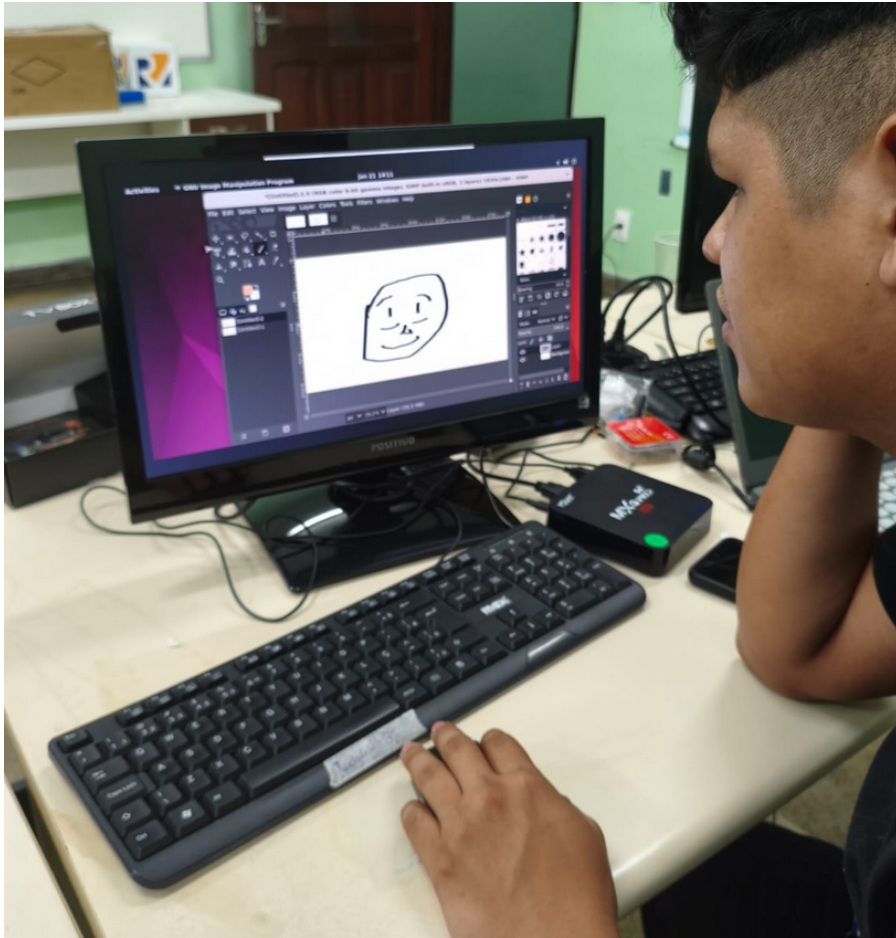
Figura 3. Estação de trabalho sustentável com TV Box reaproveitada.
