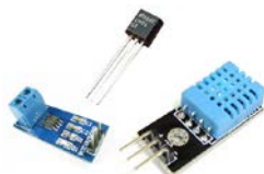
Figure 2. Sensores mais utilizados para medição de temperatura e umidade.
