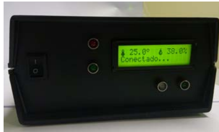
Figure 3. Protótipo de monitoração e controle de temperatura e umidade.
