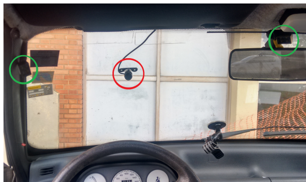
Figura 1. Posicionamento da câmera e faróis no veículo.
