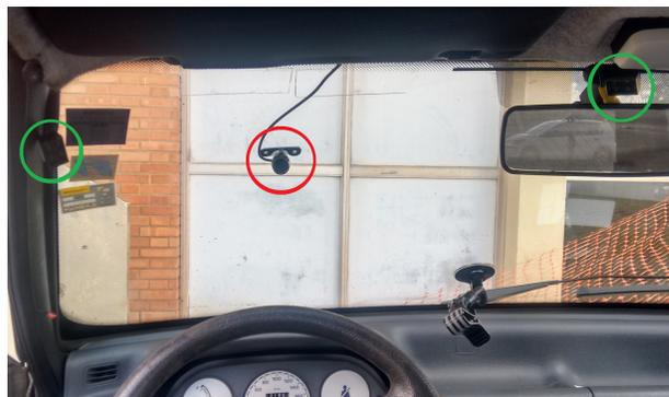
Figura 1. Posicionamento da câmera e faróis no veículo.
