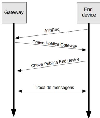
Figura 3. Protocolo de troca de chaves utilizando Curve25519.
