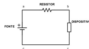
Pela Lei de Ohm, a corrente é igual à tensão dividida pela resistência. Como a resistência utilizada é igual a  $1\Omega$ , a queda de tensão medida sobre esse resistor é igual a corrente que
