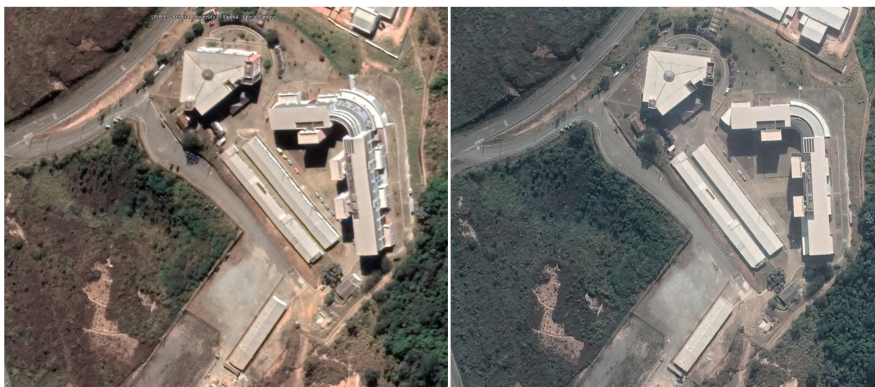
Figura 4. Imagens de satélite da RI. Na esquerda encontra-se uma imagem não apropriada para a modelagem em função de inclinações e sombras fortes, e à direita a imagem utilizada.
