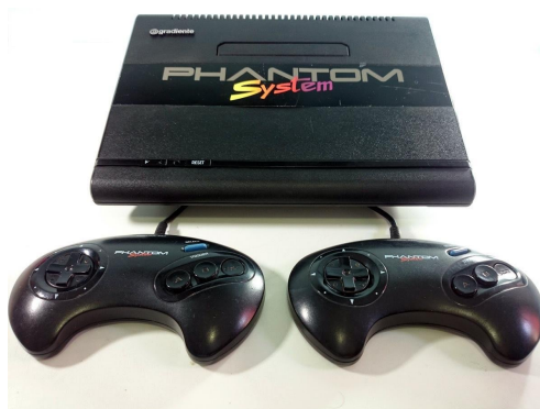
Figura 5: Console Phantom System, clone de NES da Gradiente. Fonte: [FALCÃO, 2017].
