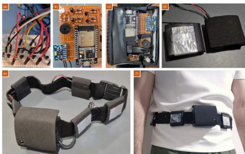
Figura 6. Evolução do protótipo do Cinto Háptico Flexível: (a) prototipação eletrônica em protoboard; (b) soldagem dos componentes numa PCI perfurada; (c) circuito interno do módulo principal; (d) dois tipos de módulos auxiliares; (e) protótipo do dispositivo vestível; e (f) dispositivo no corpo de um jogador.
