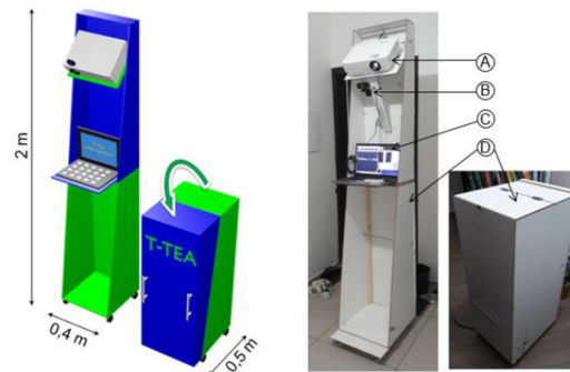
Figura 1. O console T-TEA: (A)Projektor, (B)Webcam, (C)Computador e (D)Suporte [Trindade, Pereira e Hounsell 2022].
