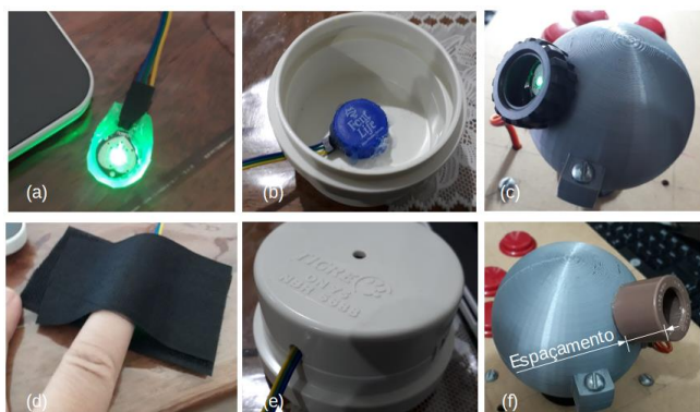
Fig. 1. Experimentos para encontrar a melhor forma de instalação do sensor de PPG. Em (a) o sensor está coberto com adesivo isolante e em (d) ele está inserido em fita velcro para fixação no dedo. Em (b) e (e), o sensor foi fixado em uma tampa com um furo para manter distanciamento entre o dedo e o sensor. Já (c) e (f), mostram configurações com espaçamento entre sensor PPG e o local do posicionamento dos dedos.
