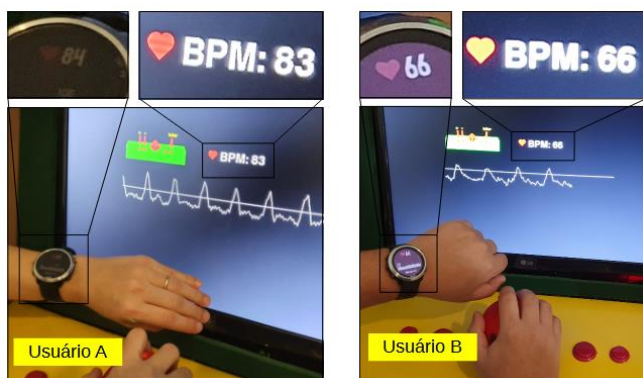
Fig. 3. Comparação entre a medição realizada pelo sensor de PPG no joystick versus a medição de um smartwatch comercial e a visualização da curva de bpm.
