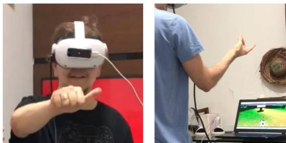
**Figura 2. Participante usando os óculos com o acoplamento de um Leap motion (esquerda) e realizando a interação com as mãos (direita).**
