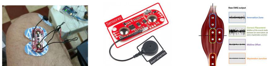
Figura 3. Sensor EMG, seu posicionamento na extensão muscular e funcionamento.
