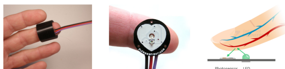
Figura 2. Sensor de Pulso Amped, posicionamento e seu funcionamento.
