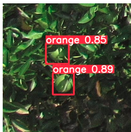
Figura 2. Imagem do conjunto de teste processada pelo algoritmo, com o grau de confiança de cada caixa delimitadora.
