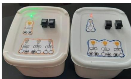
Figura 3. Caixa de operadores lógicos AND e OR
