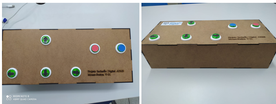
Figura 2. (A) Mouse Button visto por Cima - (B) Mouse Button Lateral
