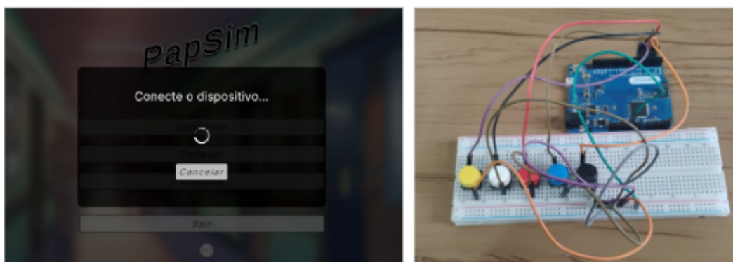
Figura 7. (esquerda) Representação das ações no simulador físico-digital. Figura 8. (direita) Integração do Digispark com botões programáveis para o jogo.
