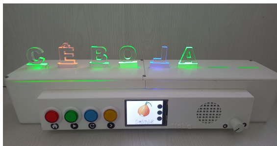
Figura 1. Alfaba em funcionamento: montagem da palavra “cebola” com feed-back visual de acertos (verde), erro (vermelho) e letra espelhada (azul).
