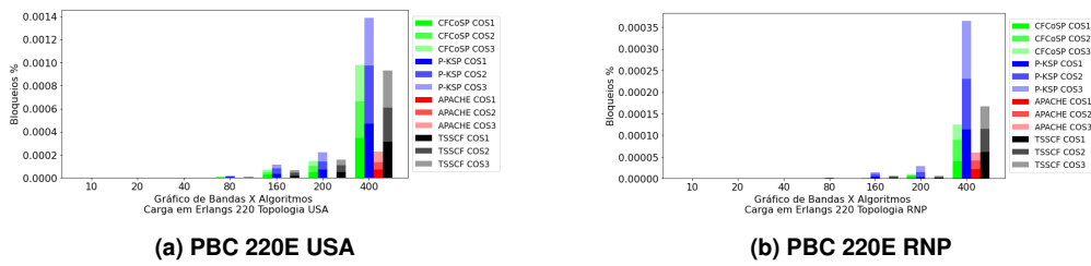
Figura 5. Probabilidade de bloqueio por classe, com carga fixa em 220 Erlangs, variando Banda x Algoritmos
