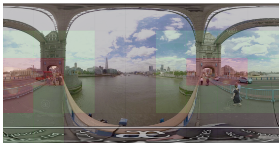
Figura 1. Codificação guiada por saliência: os quadros possuem forma equiretangular e são segmentados em tiles , onde tiles em vermelho indicam regiões codificadas com maior qualidade, tiles em verde representam qualidade intermediária e tiles em preto correspondem a regiões submetidas a maior compressão, conforme a relevância perceptual estimada.
