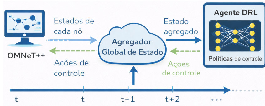
Figura 2. Fluxo temporal de execução do módulo GlobalAmBC-DRL, destacando a interação entre o OMNeT++, o agregador de estado global e o agente DRL ao longo dos ciclos de simulação.
