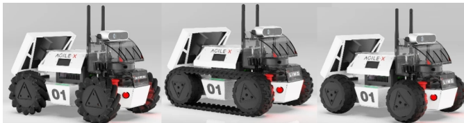
Fig. 1: Robôs LIMO disponíveis no Laboratório de Automação Inteligente e Robótica da UFES (LAB-AIR/UFES). Da esquerda para a direita: omnidirecional, com esteira e Ackermann/diferencial.
