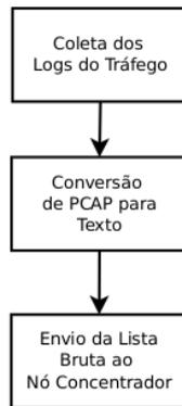
Figura 4. Módulo de coleta no servidor WEB
