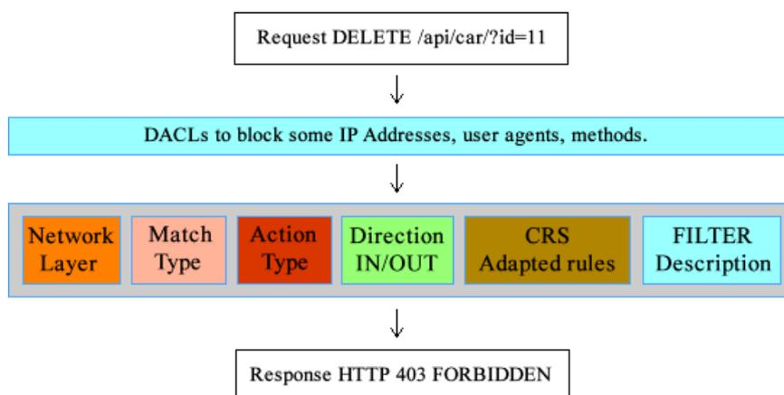
Figura 5. Estrutura de um dos filtros do firewall ilustrado na cor cinza.
