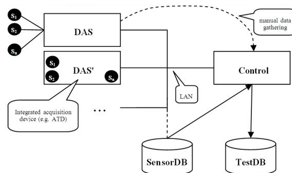
Figura 1. Visão geral da arquitetura de instrumentação de um teste de impacto.
