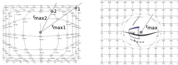
Figura 4: Visão olho-de-peixe com raio variável e fixo
