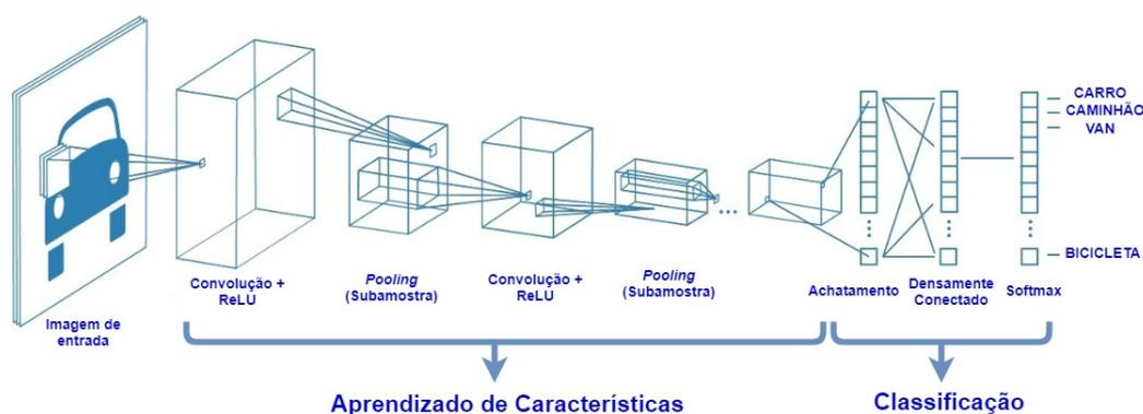
Figura 2. Exemplo de uma RNP com várias camadas convolucionais.<sup>1</sup>
