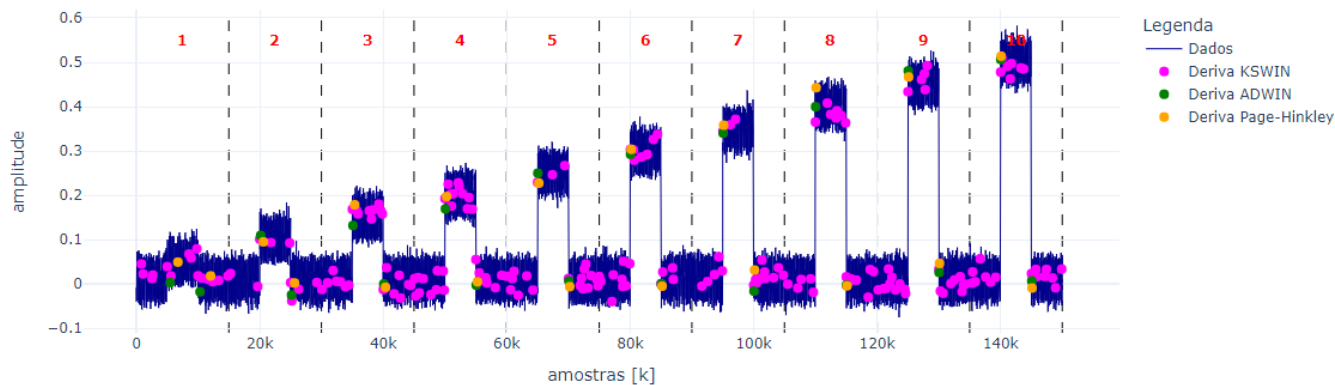
Figura 4: Série de sinais concatenados com alteração na média \mu
