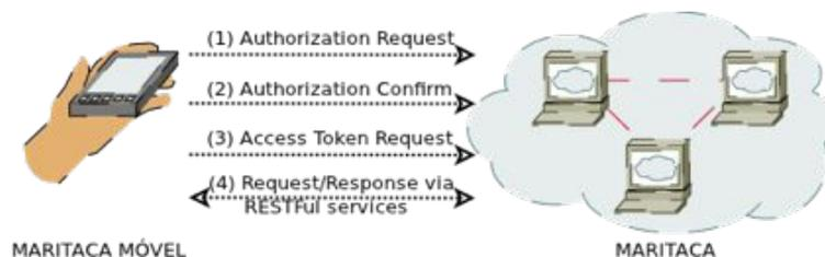
Figura 2. Modelo de autenticação entre o componente Móvel e o Servidor utilizando OAuth.
