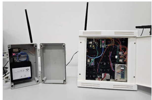
Figura 1. Estação de monitoramento externa (2ª Versão) instalada em caixa de proteção.
